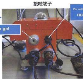
USB端子 USBハブに挿したUSBメモリーに撮影データを保存
